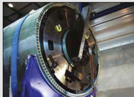
▲ Fresatrici circolari per la produzione di turbine eoliche.
