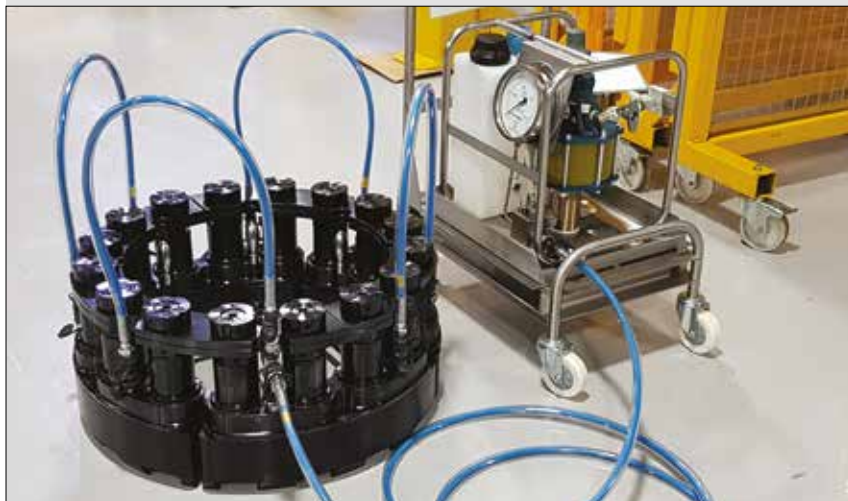
▲ Allestimento per il tensionamento di più bulloni.
