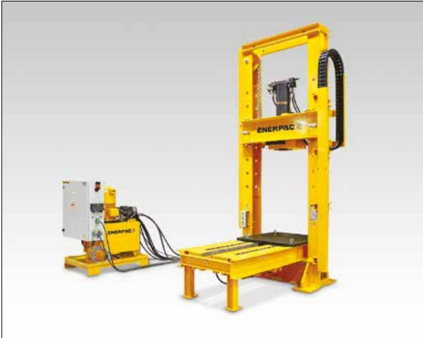
▲ Certaines interventions en mer imposent d'assembler et de tester des vérins à accumulateur haute capacité. Une presse à cadre mobile spéciale de 100 tonnes dotée d'un vérin à course longue a été construite à cet effet. Tous les mouvements sont effectués et contrôlés au moyen d'une télécommande.
