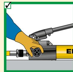
✓ Fermer le robinet de décharge à manuellement. L'utilisation d'une force plus grande détériorera le robinet.
