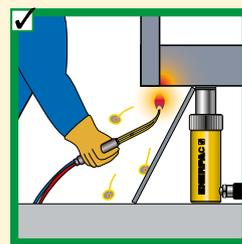
Pas de flammes à proximité de votre équipement hydraulique, éviter les températures au-dessus de 65 °C.
