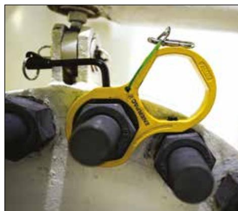
▼ Photo : STTLS31055 Safe T™ Torque Lock système de verrouillage de couple
