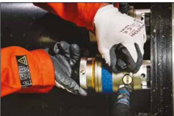
◀ Les tendeurs HydraMax® série HM d'Enerpac ont été conçus pour produire des charges de boulons élevées sur des brides compactes, tout en offrant une grande polyvalence pour fonctionner sur un maximum de boulons.
