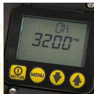
Écran LCD rétroéclairé disponible pour les pompes électriques des séries ZU et ZE ▶
