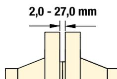
Outil mécanique destiné aux brides de petit diamètre de basse pression présentant une fenêtre d'accès d'au moins 2 mm.
