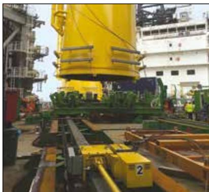
▼ Chariot électrique de la série ETR soumis à un test d'acceptation en usine avant expédition.
