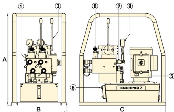
◀ Série SFP à réservoir de 20 litres (représentée avec deux sorties à débits séparés)
