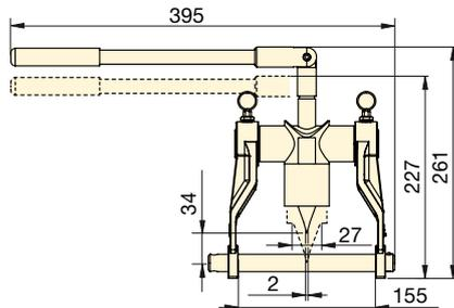
Rétraction et déploiement de l'outil à l'aide d'une petite barre d'écartement (Ø 16 mm)
