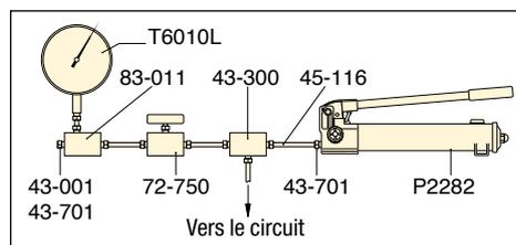
▲ Circuit d'essai type avec un robinet coupe-circuit
