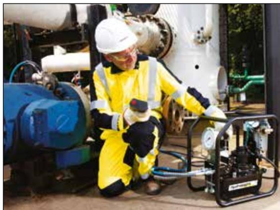
◀ La plupart des clés dynamométriques hydrauliques peuvent être actionnées par les pompes pour clés dynamométriques Enerpac série ZA4T.
