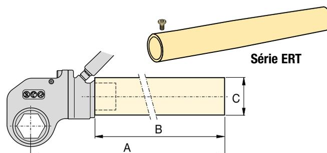
▼ Unité de commande RSL avec cassette hexagonale Slimline RLP...SL interchangeable
