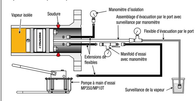
Disposition d'un test de pression d'isolation MITT
