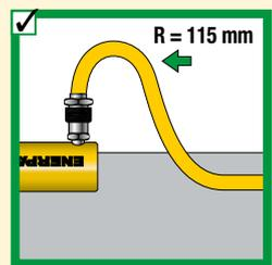
✓ Ne pas plier les flexibles. Le rayon de courbure ne doit pas être inférieur à 115 mm. Ne pas rouler ou laisser tomber des objets lourds sur les flexibles.
