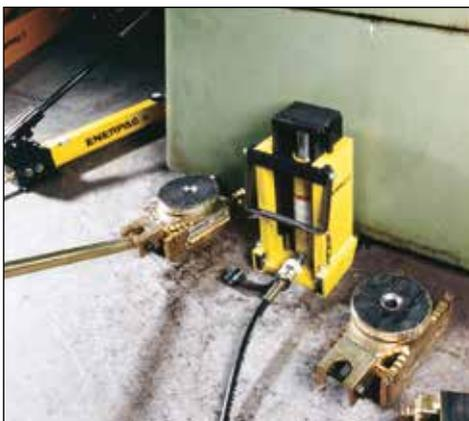
▼ Transport d'une cuve de produit chimique: la cuve a d'abord été surélevée de quelques centimètres avec des vérins galette série RCS puis placée sur des patins rouleurs pour être facilement déplacée.
