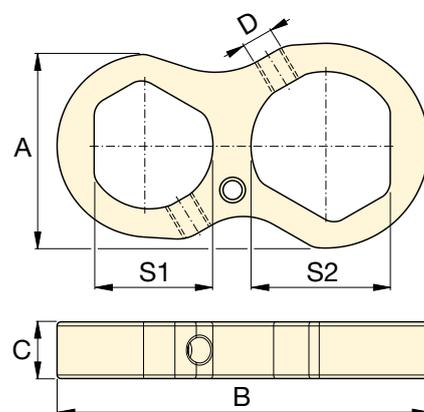
▼ Les contre-clés Enerpac empêchent le contre-écrou de tourner pendant le montage ou le déblocage.
