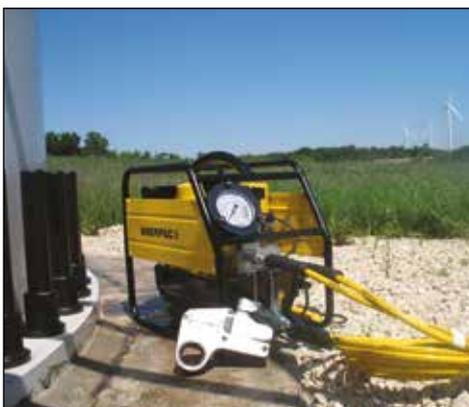
La TQ700E et les clés de série W sont une combinaison productive dans les applications éoliennes.
