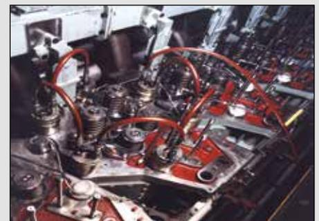
▲ Écrous hydrauliques sur moteur diesel
