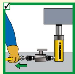
✓ Ne pas désaccoupler le vérin avant que le piston ne soit complètement rentré, ou utiliser des valves coupe-circuit, ou de sécurité bloquant la pression du vérin.
