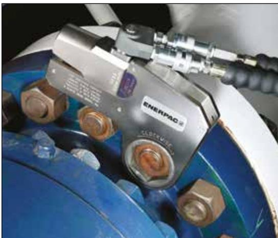
◀ Les pompes pour clés dynamométriques de la série ZE4T conviennent parfaitement à cette clé W2000X.
