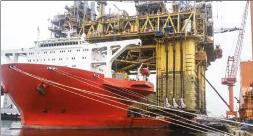
▲ Afin de procéder au super-levage et au lancement d'un système de production de pétrole flottant de pas moins de 43 000 tonnes en Malaisie, pour la plateforme offshore de Gumusut-Kakap, tout a été mis en œuvre pour privilégier la sécurité en utilisant des systèmes hydrauliques synchronisés EVO extrêmement sophistiqués dévolus au levage, à l'équilibrage, au pesage et à la pose tout en délicatesse d'imposantes structures.
