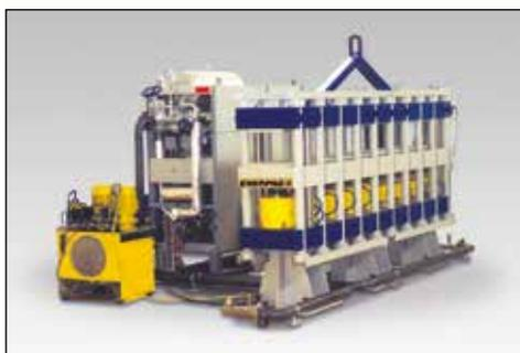
◀ Presse entièrement automatique de haute précision à automate (1800 tonnes). Le cycle de pressage et de chauffage, lors de la production de bobines d'accélération magnétiques, nécessitait une grande force et une grande précision pour garantir une qualité absolue.
