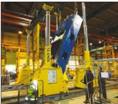
▼ Un portique SBL1100 déchargeant un grand générateur pour l'installer dans une centrale électrique.
