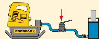
Les distributeurs peuvent être à commande manuelle ou électrique
