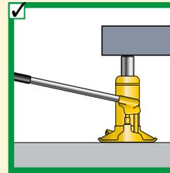
La surface totale de la tête du cric doit être en contact avec la charge. Le mouvement de la charge doit se faire dans la même direction que celle du piston.
