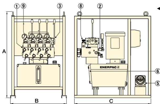
◀ Série SFP à réservoir de 40 litres (représentée avec quatre sorties à débits séparés)
