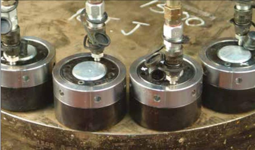
▲ Mise en tension avec écrous hydrauliques
