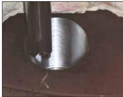
▲ Nueva rosca mecanizada
