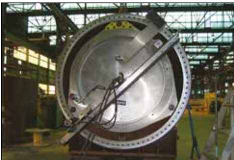
▼ Mecanizado de torre eólica con WP4600.
