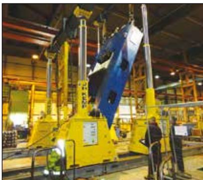
▼ El pórtico SL400 utilizado para descargar e instalar una nueva prensa de conformación.
